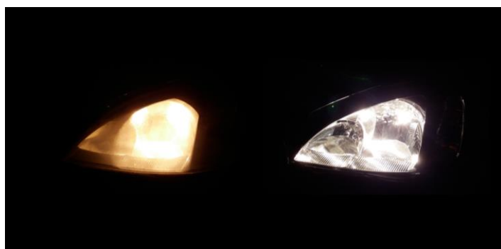
Figura 6 – À esquerda, farol com lente degradada. À direita, farol novo.
